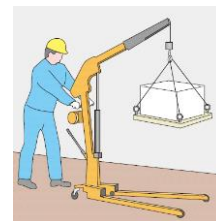
吊荷状態での手押し移動に
