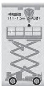
高所作業車のバスケットが上昇する際に構造物との衝突を未然に防ぐ装置です。超音波センサーのエリア内に障害物が入ると、電子音にて運転者に注意を促します。
