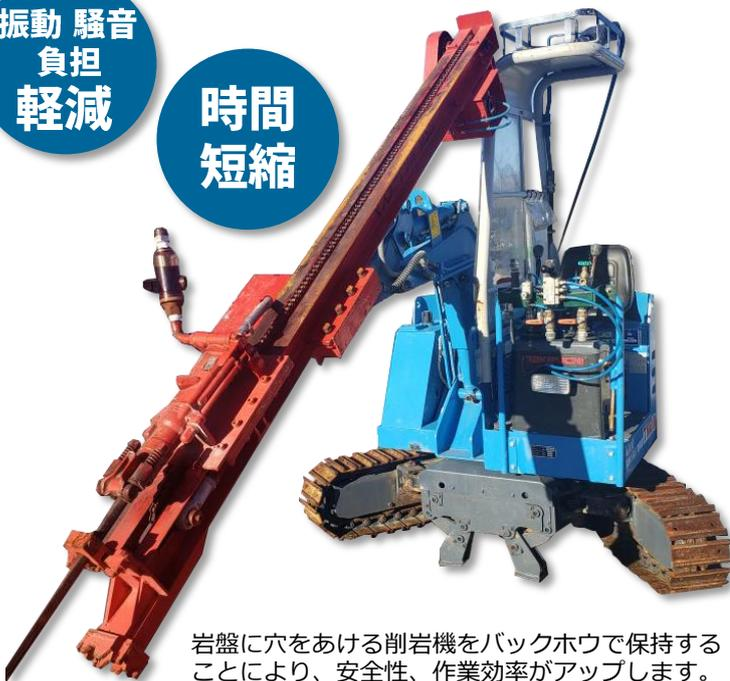
岩盤に穴をあける削岩機をバックホウで保持することにより、安全性、作業効率がアップします。また、削岩能力、深さ、速度角度などが容易に決められます。
