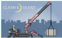
200Vの電動パワーユニットを装備し、電動モーターでクレーン作業・走行ができます。工事騒音が問題となる夜間や住宅街が近接する現場ではエンジン騒音がない電動モーターで作業。状況に応じて運転の切り替えができるため、エンジン運転で作業効率を優先させることも可能です。
